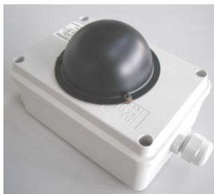
Датчик температуры обеспечивает возможность постоянного контроля температуры в помещении (температуры комфорта), которая создается инфракрасными излучателями. Эта температура является средней от температуры воздуха и температуры излучения. Датчик температуры позволяет оптимально регулировать работу излучателей. Благодаря небольшим размерам и герметичности пластмассового корпуса датчика, его можно устанавливать в любом месте помещения.
